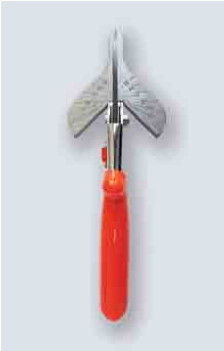
Universal-Gehrungsschere Artikel-Nr. 550.0020 für 45 und 90° Schnitte 50 mm Schnittlänge
