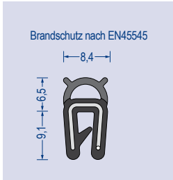
Artikel-Nr. 561.8249 EPDM-Weichgummi/ EPDM-Moosgummi · schwarz Brandschutzqualität nach EN 45545 Klemmbereich 1-2mm VE: Bund á 50m
