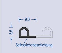
Artikel-Nr. 548.5029 EPDM · 70° Shore A · schwarz VE: Spule á 200m Lieferform: 100 Doppelmeter mit Abrißkante, als Montage- hilfe einseitig selbstklebend
